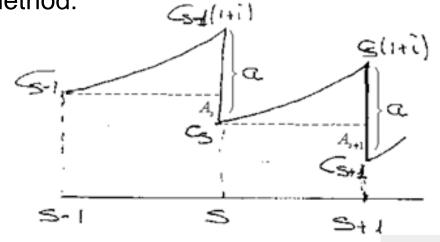
$$C_{s} = C_{s-1}(1+i) - a \Longrightarrow C_{s} - C_{s+1} = (C_{s-1} - C_{s})(1+i)$$
